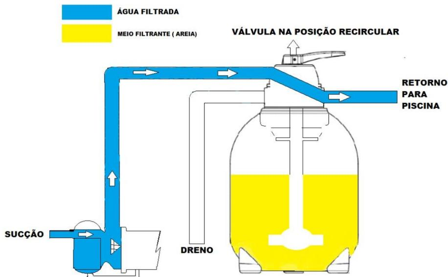
**Pré Filtrar (sai água pelo esgoto):** Esta operação deve ser realizada após a retro lavagem, já que a mesma consiste em retirar qualquer resíduo que esteja alojado dentro do tanque, principalmente na crepina. Através do visor, observa-se o aspecto da água que sai da pré-
