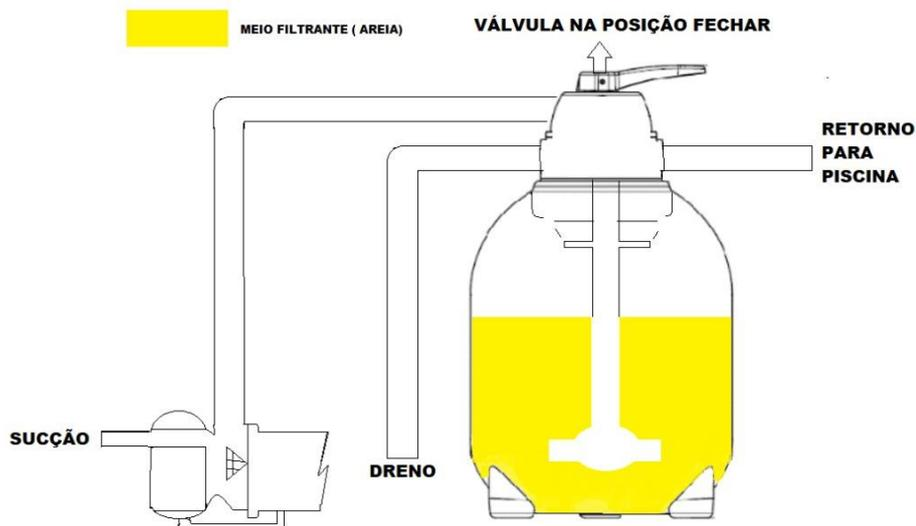
**Retro lavar (sai água pelo esgoto):** A operação retro lavar deverá realizar-se quando o meio filtrante (areia) estiver saturado por acúmulo de sujeira. Isto ocorrerá após diversos ciclos de filtragem da água.
