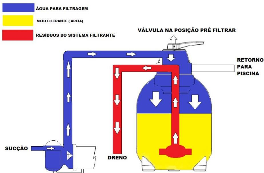
**Filtrar:** A operação filtrar é realizada quando há a necessidade de retirar o acúmulo de sujeira do interior da piscina, sem possibilitar o retorno da mesma água, bem como, mantê-la sempre limpa e cristalina.
